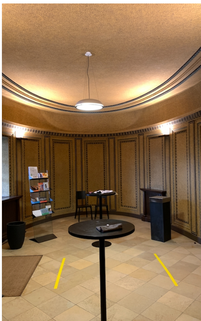
2.01 22m à 12W à 450lm, 3000K warmweiss. ca. 9900lm Profil flex vergossen ca. 20/20mm. Einladende, beruhigende und einstimmende Atmosphäre.
